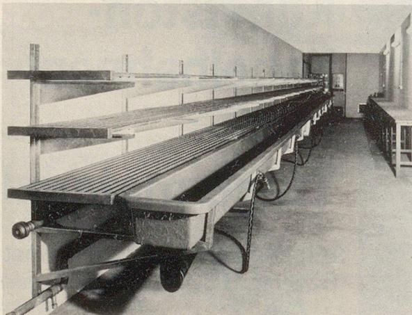
Getrocknet wird mit kondensierter Umluft:
