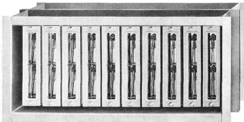
Luwa Überdruck-/Explosions-Schutzventile ÜV/ESV ermöglichen den Abschluss der Abluftöffnungen in zivilen und militärischen Schutzräumen. Sie gewährleisten einen wirksamen Schutz gegen vorlaufende Stosswellen mit Druckstärken bis 3 atü.
