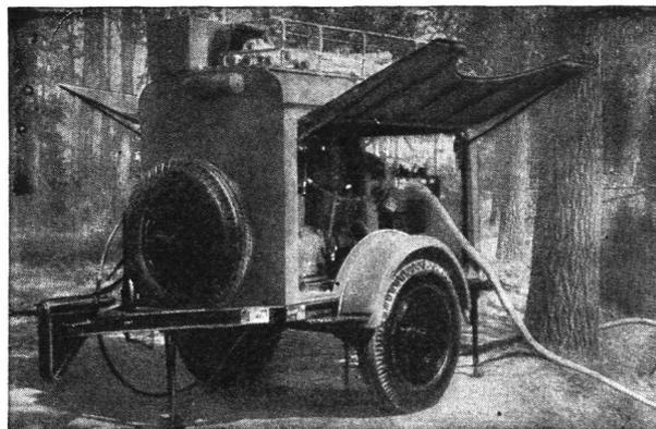
Trinkwasserbereiter mit elektrolytischer Chlorerzeugung 10 m<sup>3</sup>/h. Ein-
