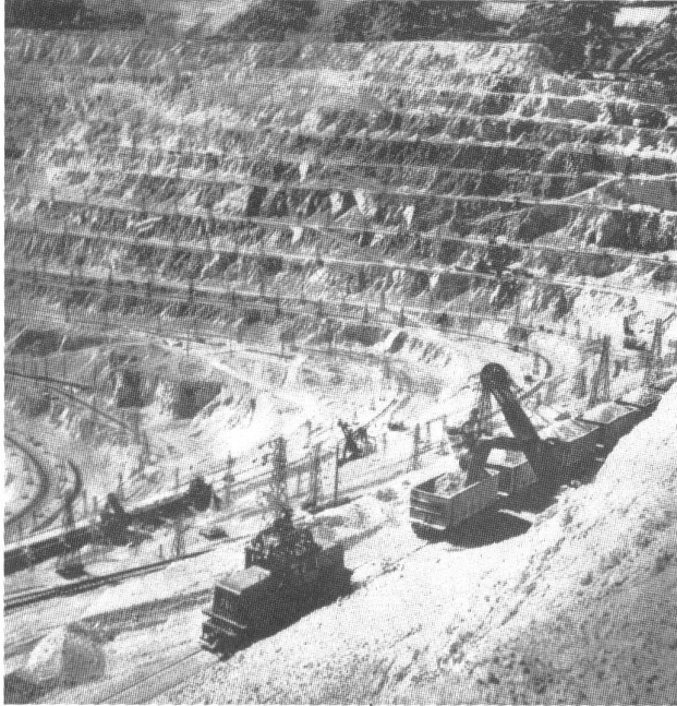
Kupferabbau: Löffelbagger beladen Eisenbahnwagen mit Kupfererz
