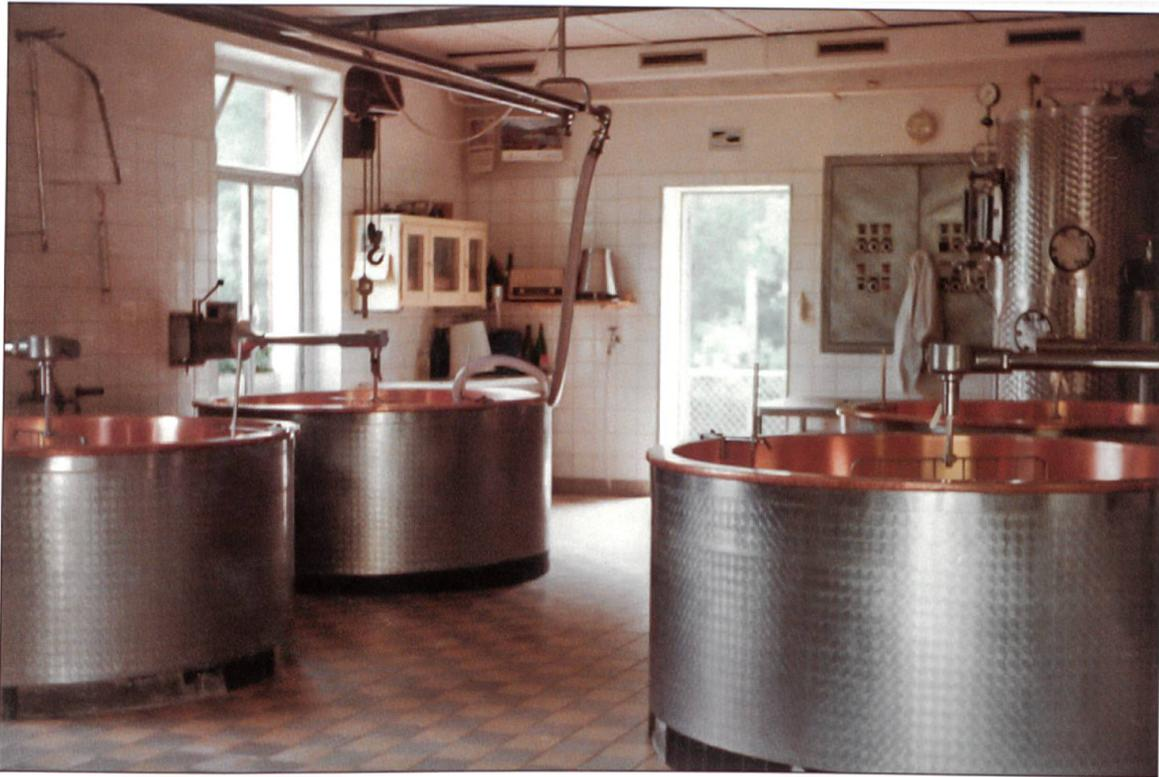
*Käserei Hofstetten, Willisiau, 1968–1987: Käseküche mit vier Käsekessi, Dampfkessel im Hintergrund (Dampferzeugung mit Heizöl). Foto Pius Oggier*
