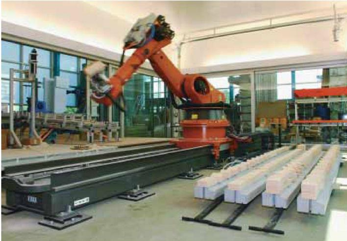
Digitales Kugelmodell zur Genesis des Ornaments von Gramazio & Kohler (oben) und Fertigung der Wandelemente durch einen Roboter an der ETH Zürich (unten).
