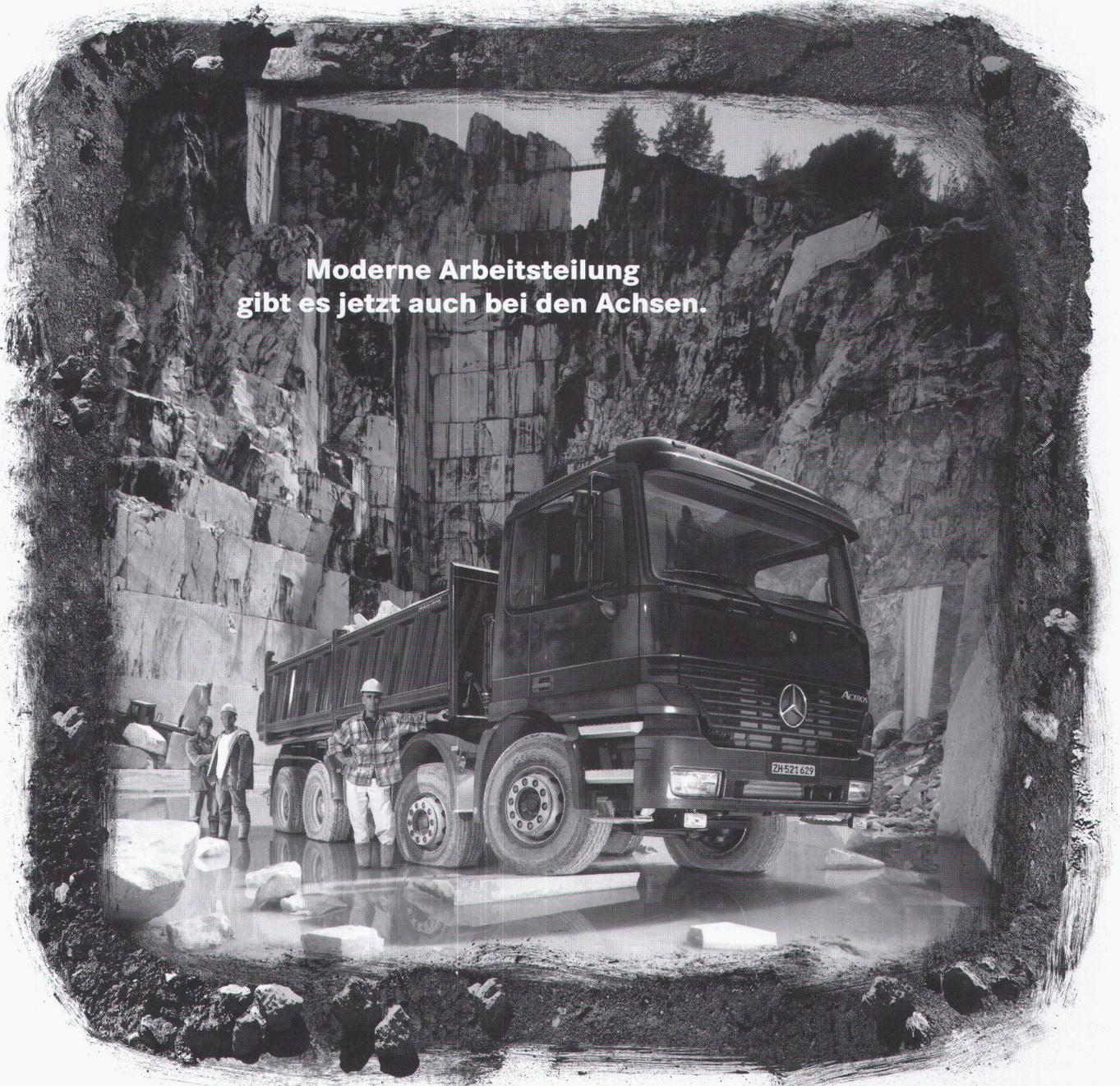
«Einer trage des anderen Last» – das gilt jetzt auch für Achsen. Bei jeder Bodenwelle und bei jedem Hindernis, das überfahren wird, bekommt normalerweise immer nur eine Achse die volle Wucht des Stosses ab. Anders beim weltweit ersten Achslastausgleich für Vierachser: Er verteilt die Last gleichmässig auf beide Vorderachsen und baut so Belastungsspitzen ab. Diese moderne Art der Arbeitsteilung schont Material,
