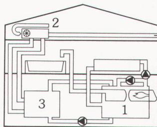
Bi- oder multivalente Heizsysteme ermöglichen es, durch eine sinnvolle Kombination sowohl Primär- als auch Alternativenergien zu nutzen.
