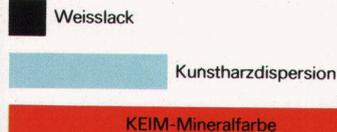
KEIM-Farben sind voll wasserdampfdurchlässig. Die im Baukörper enthaltene Feuchtigkeit kann ungehindert nach aussen abgegeben werden. Schäden werden verhindert, die Wärmeisolierung bleibt erhalten. KEIM-Farben sind gasdurchlässig. Putz und Mörtel können CO<sub>2</sub> aus der Luft aufnehmen und voll karbonatisieren. Dadurch bleiben die Fassaden gesund.
