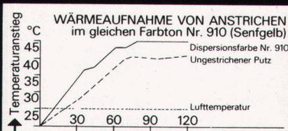
KEIM-Farben haben eine mikro-kristalline Struktur, d. h. Licht- und Wärmestrahlen werden reflektiert. Die Brillanz der Keimfarben ist unübertroffen. In heißen Klimazonen wird durch die Reflexion der Infrarotstrahlen die Wärmebelastung der Baukörper erheblich reduziert.
