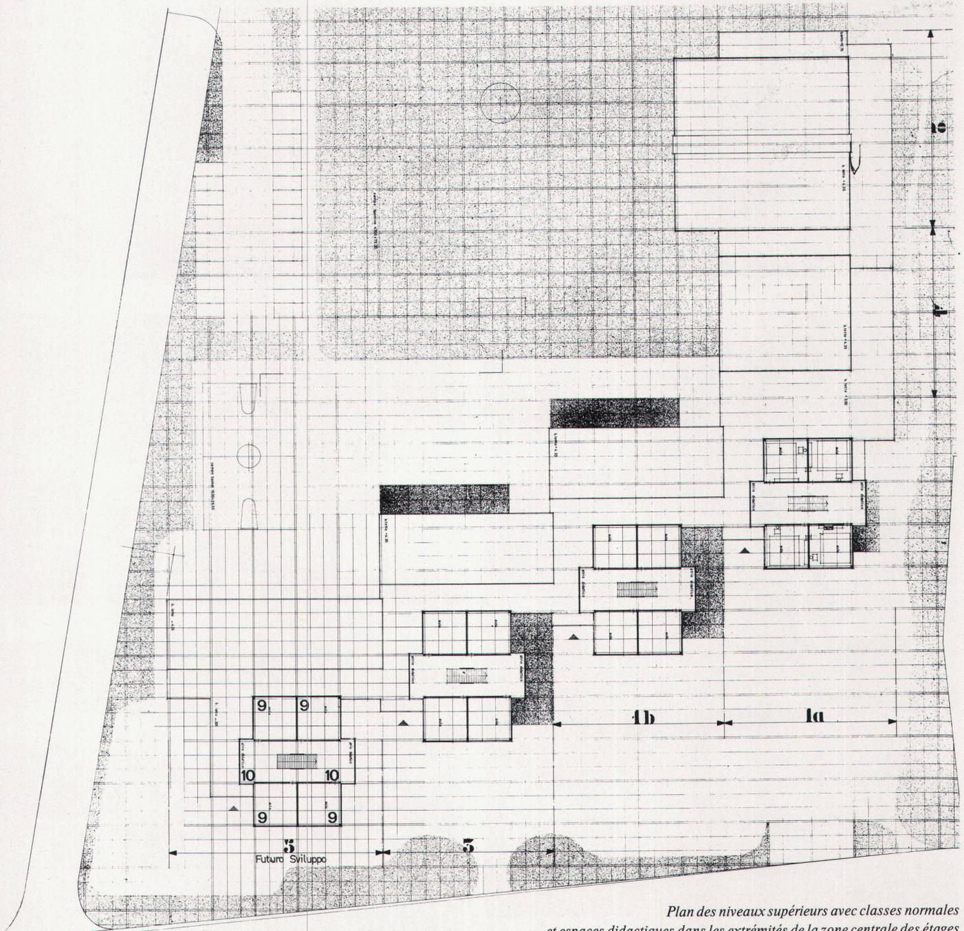
Plan des niveaux supérieurs avec classes normales et espaces didactiques dans les extrémités de la zone centrale des étages
