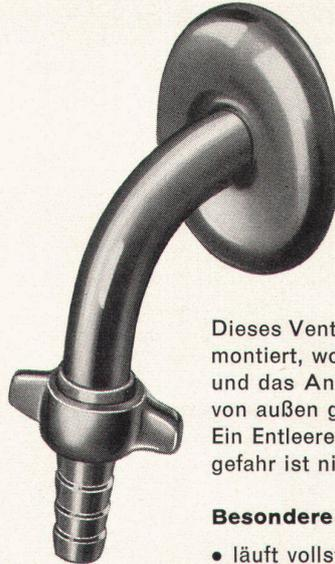
Dieses Ventil wird im Innern des Hauses montiert, wogegen dessen Betätigung und das Anschließen des Schlauches von außen geschehen. Ein Entleeren des Ventiles wegen Frostgefahr ist nicht notwendig.
