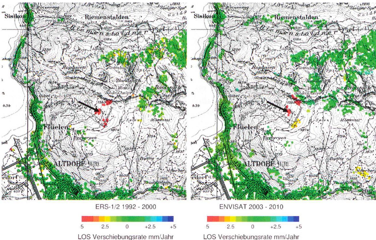
Fig. 9: Mittlere Verschiebungsrate im Gebiet des hinteren Gruontals in den Jahren 1992–2000 (Satellit ERS; links) und 2003–2010 (Satellit ENVISAT, rechts); Massstab ca.  $1 : 80'000$ . Der schwarze Pfeil markiert einen Punkt, von dem die Verschiebungsdaten in einer Zeitreihe dargestellt sind (Fig. 10).
