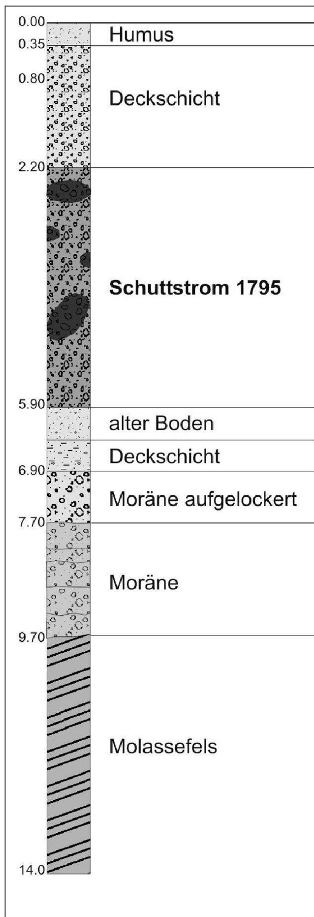
**Fig. 7:** Bohrprofil (vereinfacht) im Kegelhalsbereich des Schuttstromes.
