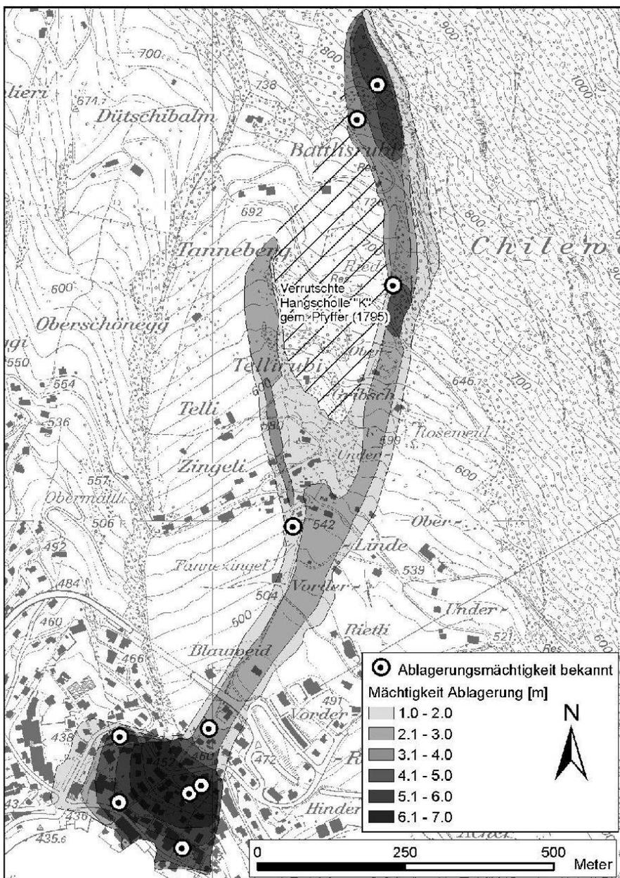
**Fig. 8:** Ablagerungsmächtigkeiten im terrestrischen Wirkungsraum des Schuttstromes.
