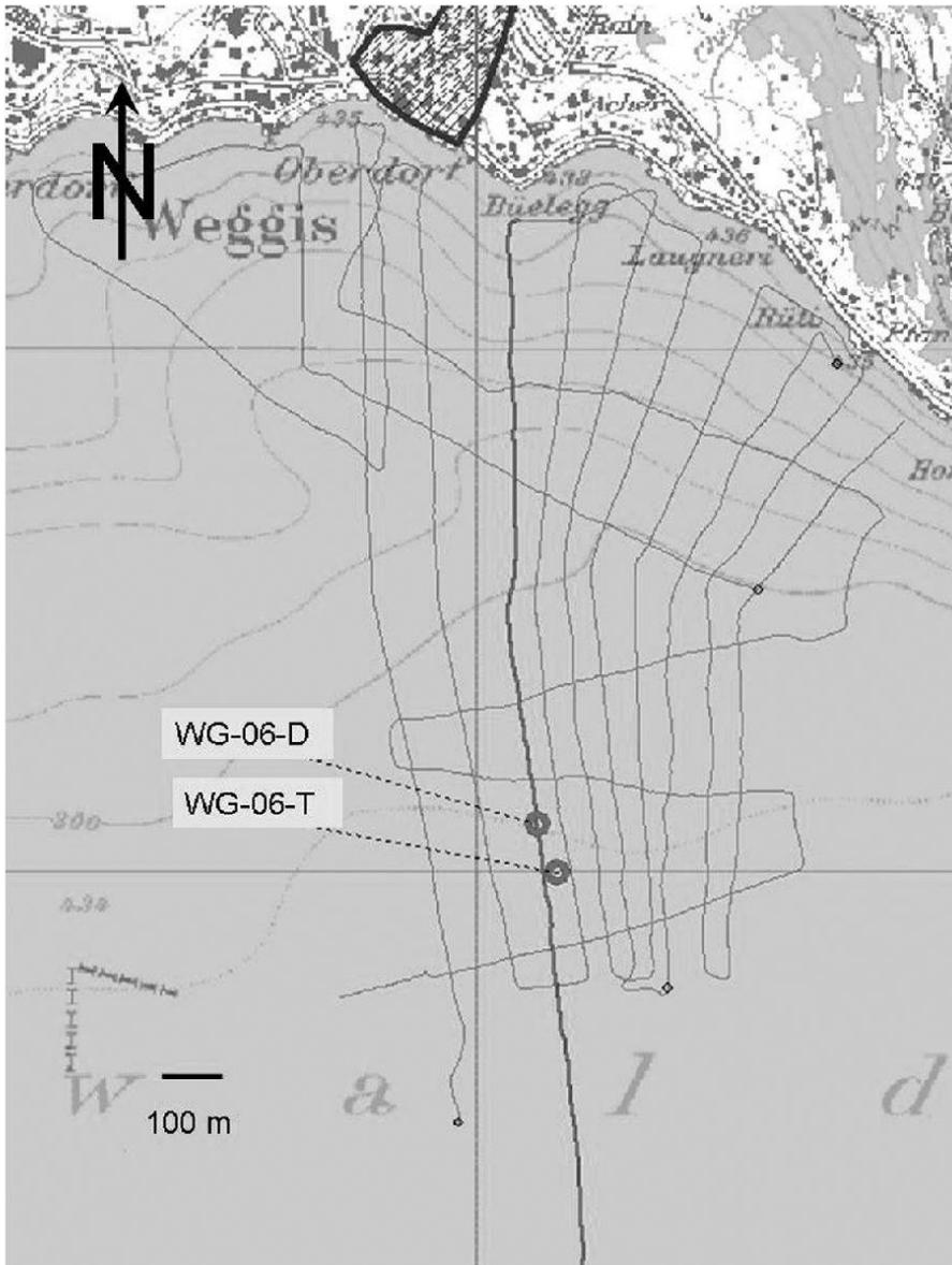
**Fig. 10:** Karte vor Weggis: seismisches Netz, mit der dargestellten Profillinie (dunkel) und den zwei Kernbohrungen WG-06-D und WG-06-T. Die schraffierte Fläche im Bereiche des Oberdorfes zeigt die Ausbreitung des Schuttstromes entlang des Seeufers.
