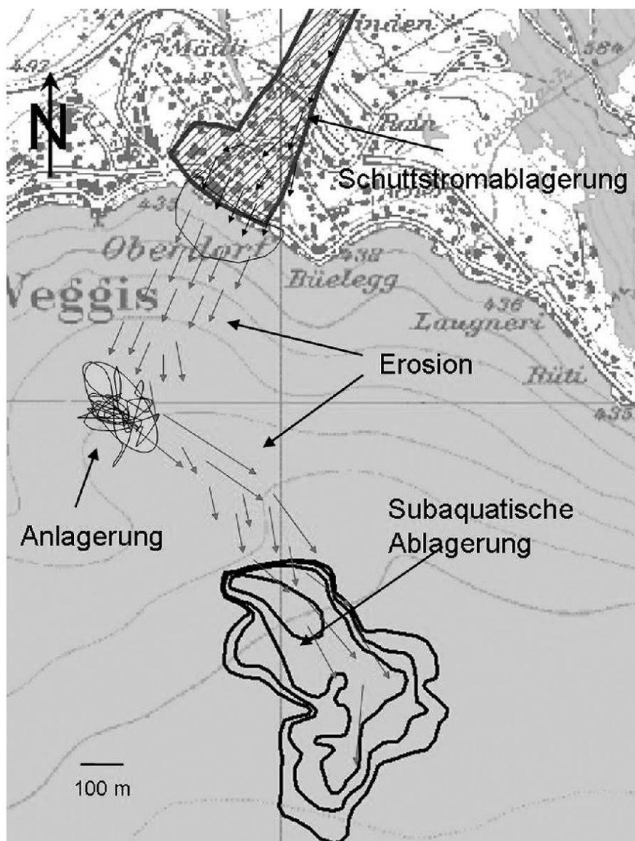
**Fig. 13:** Fließpfad der Rutschmasse und deren Ausmass (Äquidistanz der Ablagerungskurven: 0.7 m) mit einer Kubatur von ca. 140'000 m<sup>3</sup>.
