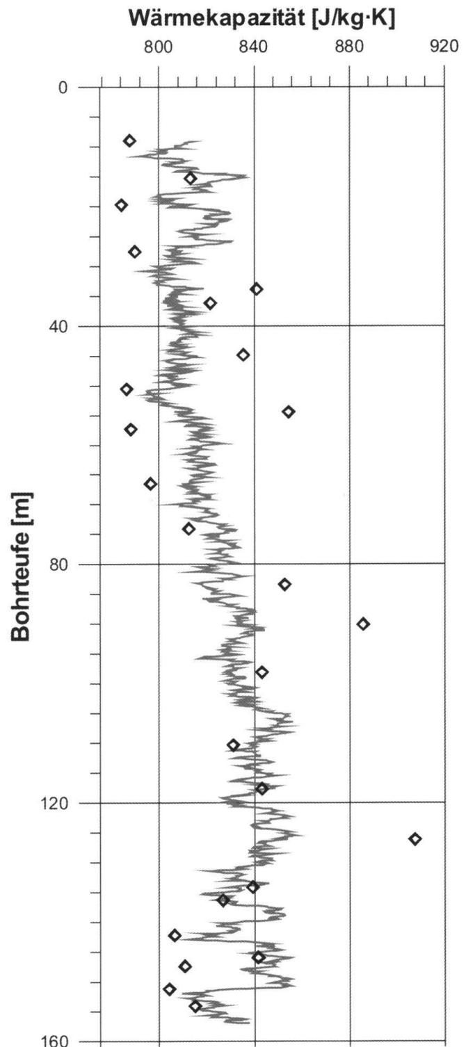
**Fig. 8:** Graph der aus den geophysikalischen Logs (Fig. 4) bestimmten Wärmekapazitäten in Relation zur Bohrtiefe und im Vergleich zu den Laborwerten (schwarze Symbole). Ausgehend von einem Mittelwert von 825 J/kg·K sind zwei Abschnitte erkennbar: OK Fels bis 53 m mit einem geometrischen Mittel der Wärmekapazität von 810 J/kg·K und von 53-160 m mit einer solchen von 830 J/kg·K (aus Geoform AG 1999).
