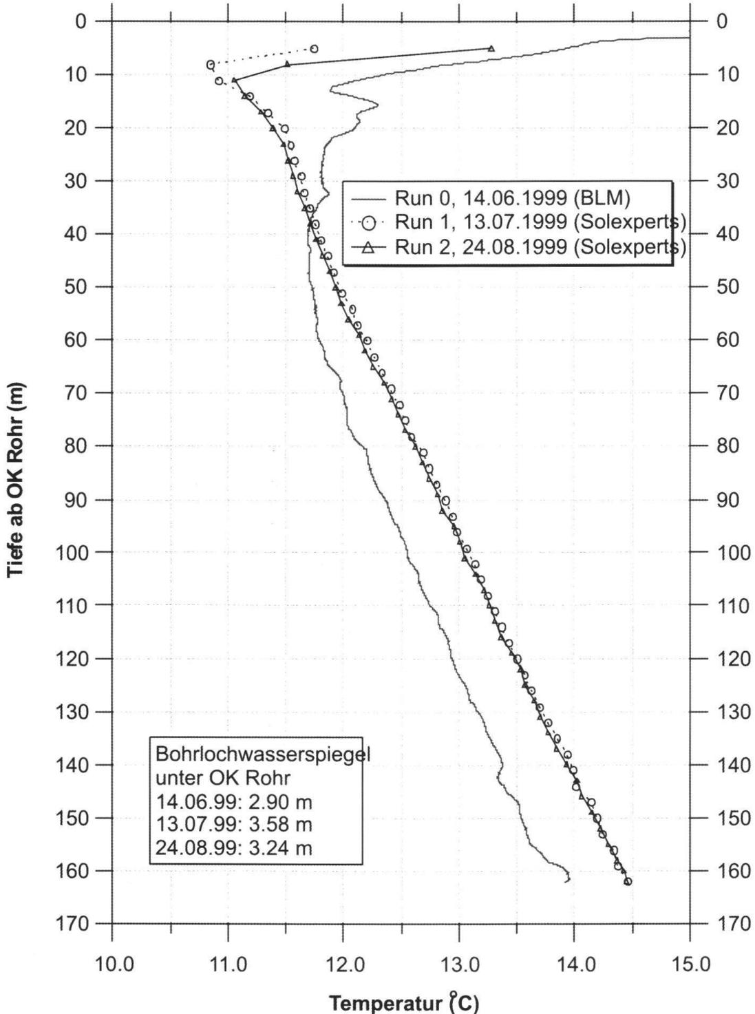
**Fig.9:** Graph der Temperaturmessungen in der Pilotbohrung (aus Solexperts et al. 1999). Run 0 zeigt den durch das Spülwasser gestörten, abgekühlten Zustand unmittelbar nach Abschluss der Bohrung. Die beiden anderen, fast deckungsgleichen Kurven (Rund 1 und 2) repräsentieren den ungestörten Zustand nach einer längeren Ruhephase. Der daraus ermittelte lineare geothermische Temperaturgradient beträgt zwischen 10 und 160 m Teufe 23.3°K/km.
