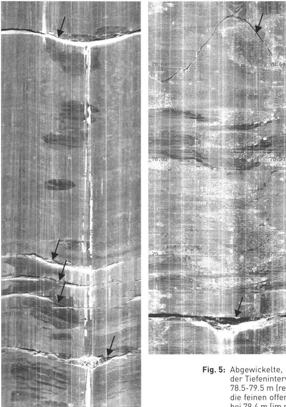
**Fig. 5:** Abgewickelte, orientierte Bohrloch-Scans der Tiefenintervalle 14.0-15.1 m (links) und 78.5-79.5 m (rechts). Deutlich sichtbar sind die feinen offenen Klüfte (Pfeile). Die Kluft bei 79.4 m (im rechten Ausschnitt unten) ist scheinbar mehrere Millimeter geöffnet.
