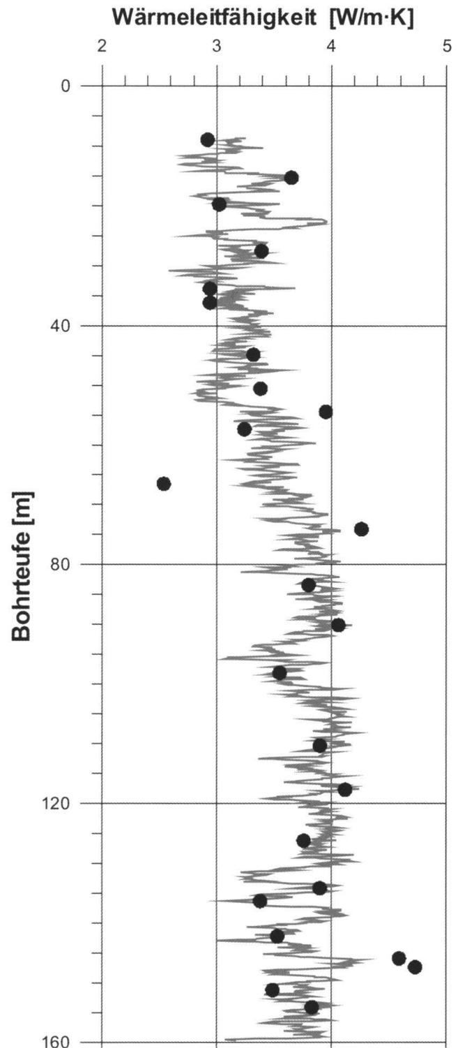
**Fig. 7:** Graph der aus den geophysikalischen Logs (Fig. 4) bestimmten Wärmeleitfähigkeiten in Relation zur Bohrtiefe und im Vergleich zu den Laborwerten (schwarze Punkte). Ausgehend von einem Mittelwert von 3.6 W/m·K sind zwei Abschnitte erkennbar: OK Fels bis 53 m mit einem geometrischen Mittel der Wärmeleitfähigkeit von 3.2 W/m·K und von 53-160 m mit einem solchen von 3.7 W/m·K.
