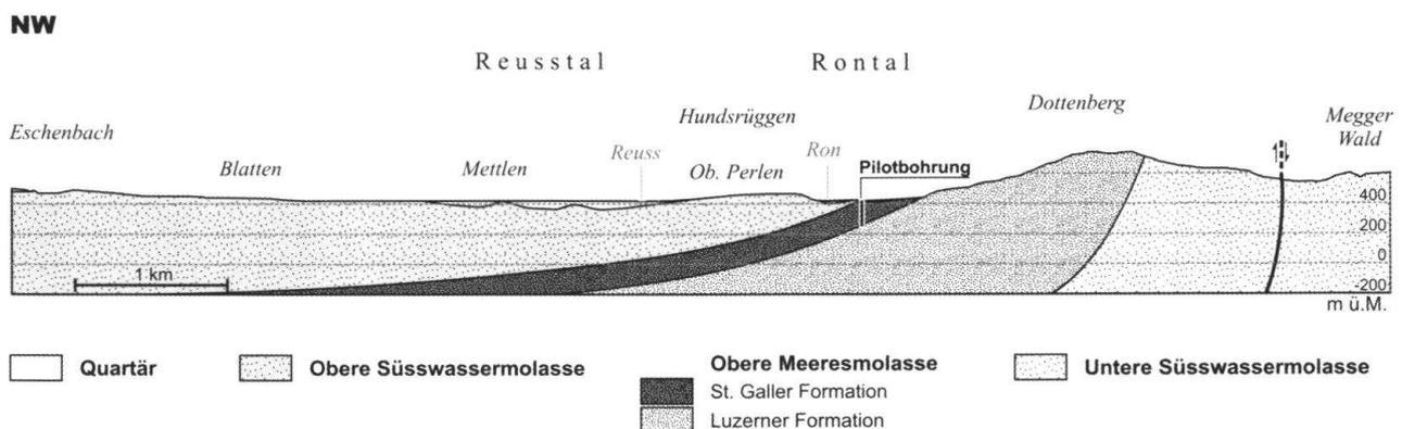
Fig. 1: Geologisches Profil durch das Rontal mit der Lage der Pilotbohrung Längenbold.
