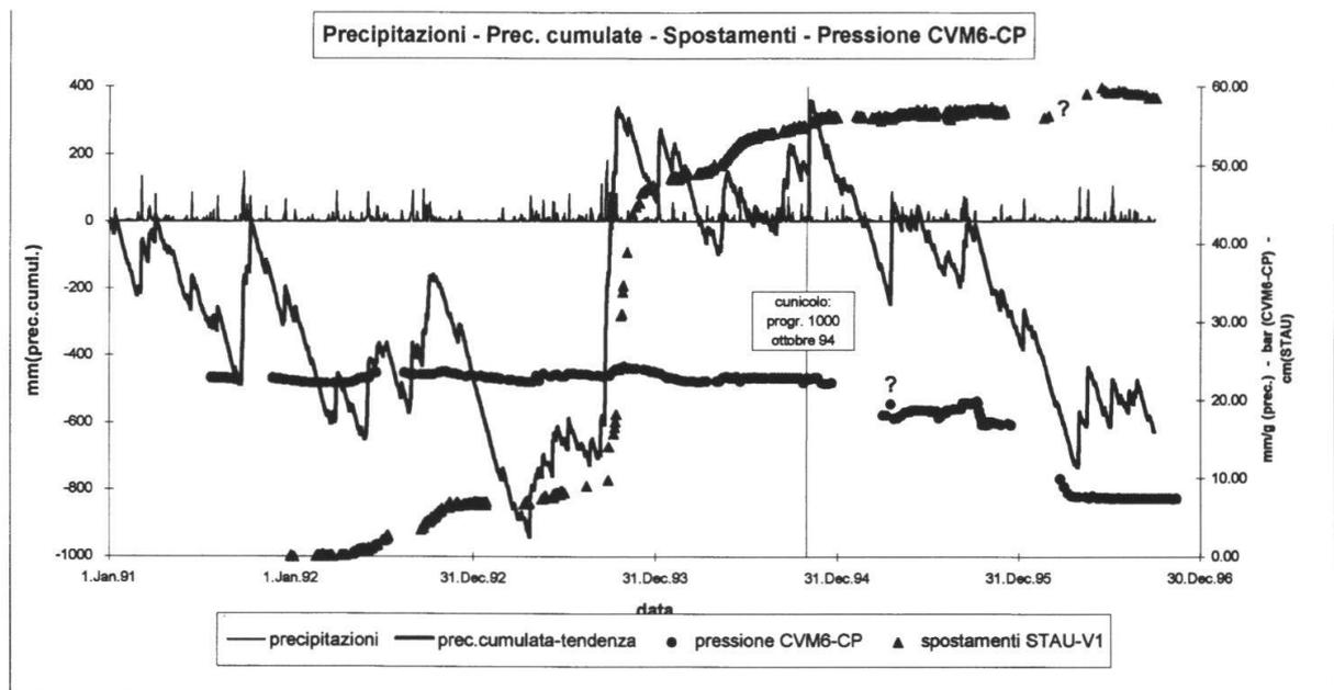
**Fig. 5:** Evoluzione delle pressioni interstiziali nella roccia (sondaggio CVM6 a -178 m di profondità) e dei movimenti, in funzione delle precipitazioni e della realizzazione del cunicolo di drenaggio.
