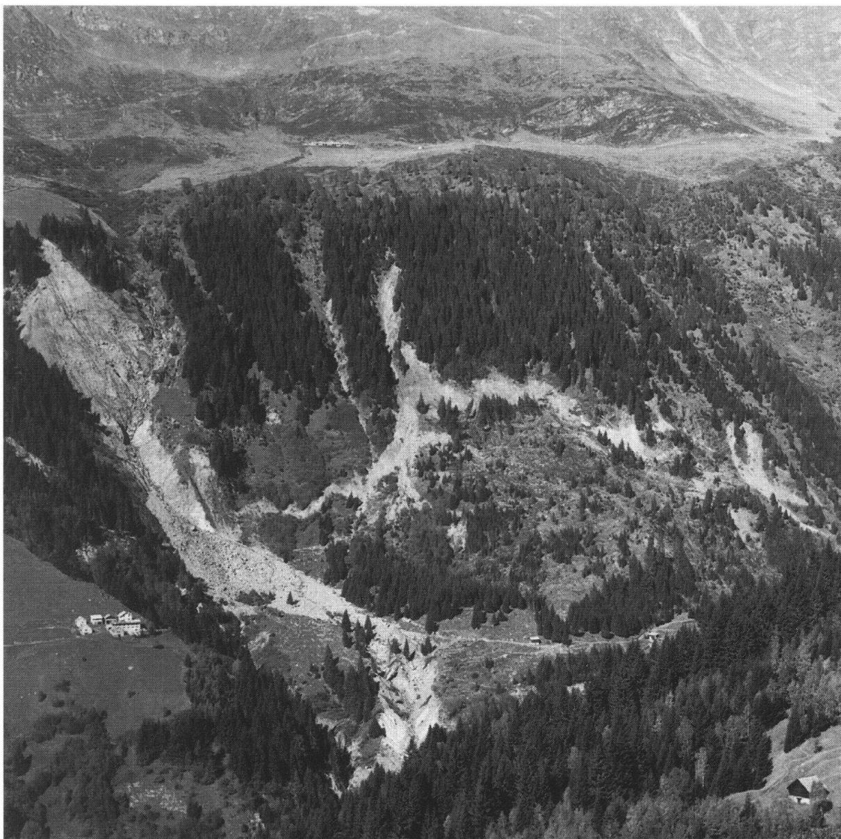
**Fig. 2:** Panoramique du glissement de Rùtan (versant droit du Val Canaria). L'hameau de Monti occupe une partie des pâturages sur la gauche (en aval par rapport au glissement). La niche d'arrachement apparaît comme un ruban blanchâtre irrégulier. En haut à gauche on remarque le grand affleurement rocheux dû à l'éboulement du Riale delle Fontanelle (novembre 1991). Au centre du cliché, vers le bas, on distingue l'important creusement produit par le Rì di Monti pendant l'alluvion de 1993.
