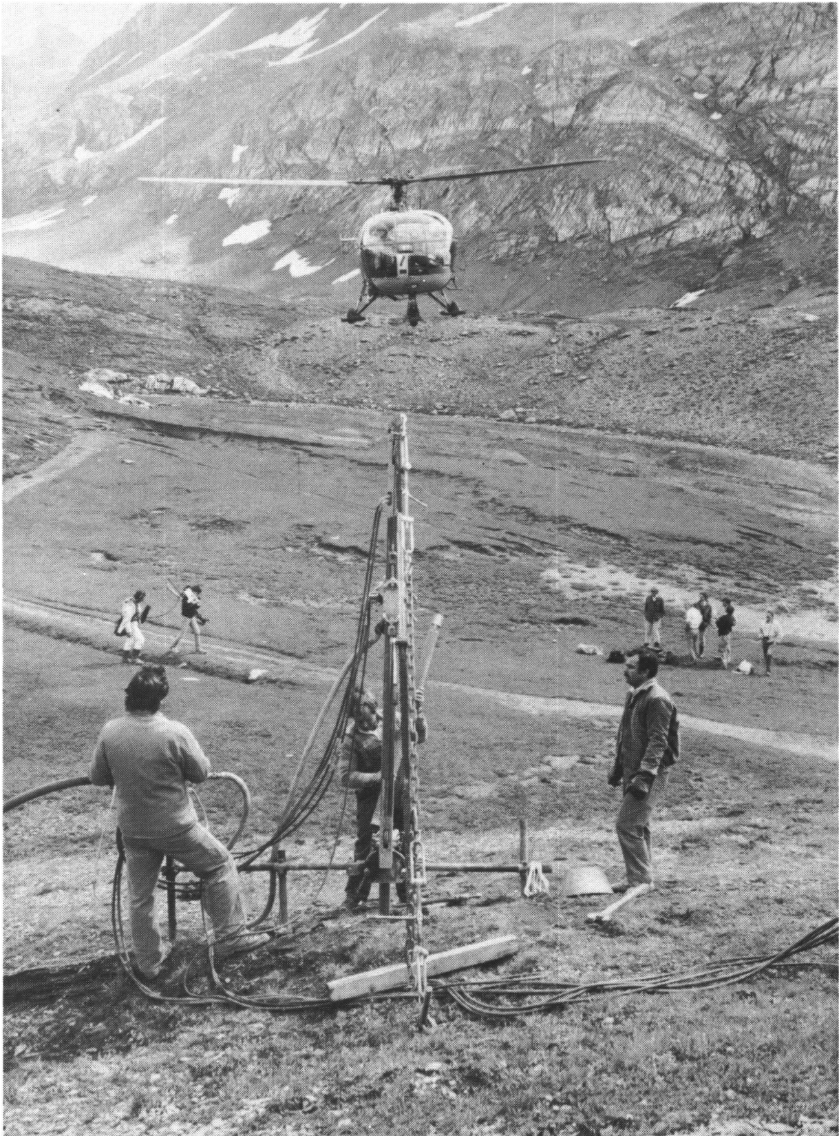
Bild 6 Bohrgerät für Sprengschußseismik auf dem Rawilpass. Zusätzlich zur Vibroseis wurden Sprengschüsse von 30 - 300 kg Dynamit zur Erzeugung akustischer Siganle eingesetzt. Je nach der Ladung werden kostspielige Bohrlöcher von 50 - 100 Meter Tiefe benötigt. Die scharfen akustischen Signale von Sprengschüssen sind für Reflexionsseismik weitaus geeigneter als Vibrationen, doch verhindern die ausserordentlich hohen Kosten eine weiträumige Verwendung.
