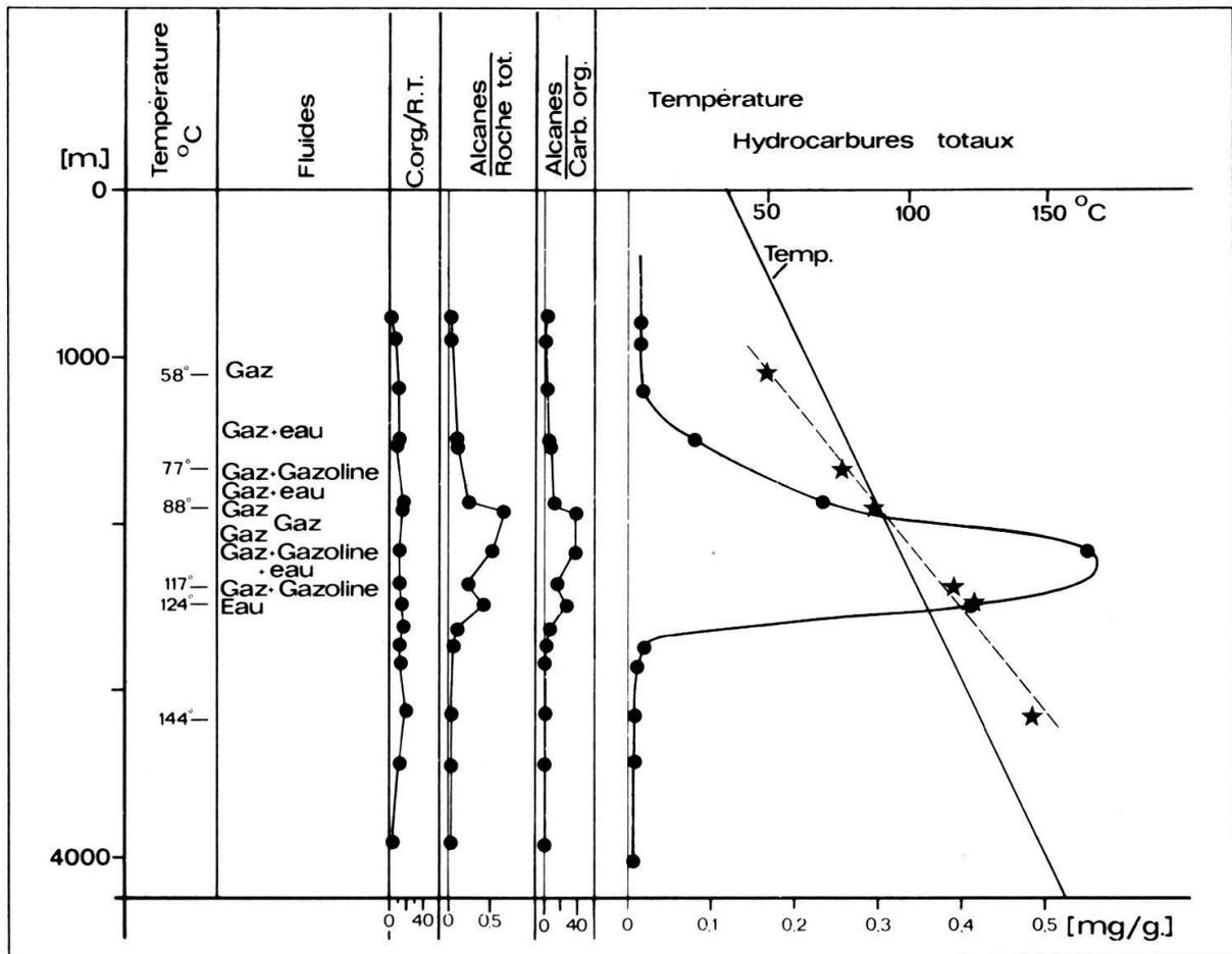
◀ Fig. 1 *Données d'analyse et schématisation de la fenêtre à huile potentielle*
