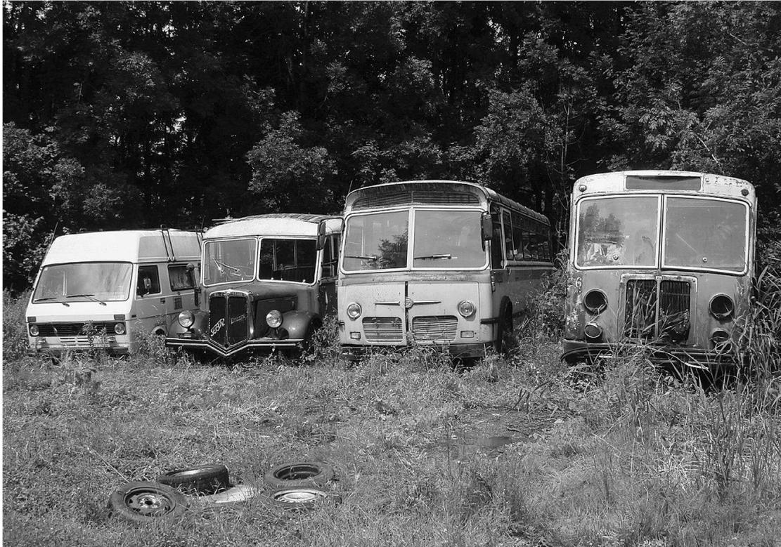
*Interessant sind die beiden in der Mitte stehenden Fahrzeuge. Links ist ein 6-Zylinder-Diesel-FBW zu sehen, der vermutlich den Jahrgang 1948 hat. Dabei handelt es sich um einen 20-Plätzer-Bus, das heisst um einen sogenannten Alpenwagen mit einem faltverdeck in der Länge des gesamten Sitzteiles. Der FBW wurde vorwiegend auf Postautolinien eingesetzt. Bei der Karosserie handelt es sich möglicherweise um eine von Ramseier & Jenzer oder um eine von Hess, Bellach.*
