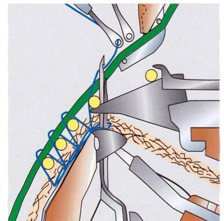
Abb. 3: Wirkwerkzeuge der RS MSUS-V bei der Vliesverarbeitung
