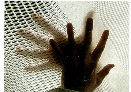
Abb.1: Abstandsgewirke in Trennwänden bieten Separation ohne Käfig-Effekte
