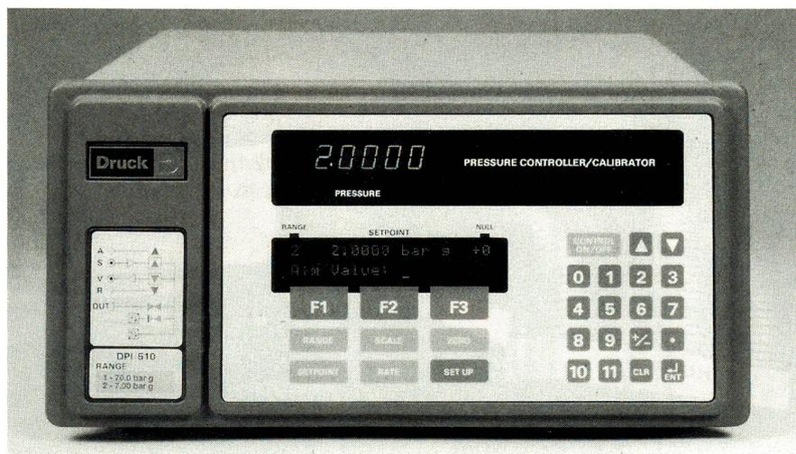
Hilfe einer digitalen Fehlerkorrektur wird die hervorragende Kalibrierengenauigkeit von 0,04% vom Messwert erreicht. Zudem kann der Anwender, falls erforderlich, das DPI 510 selber nachkalibrieren. Dafür ist serienmässig ein leicht zu handhabendes Kalibrierprogramm eingebaut.
