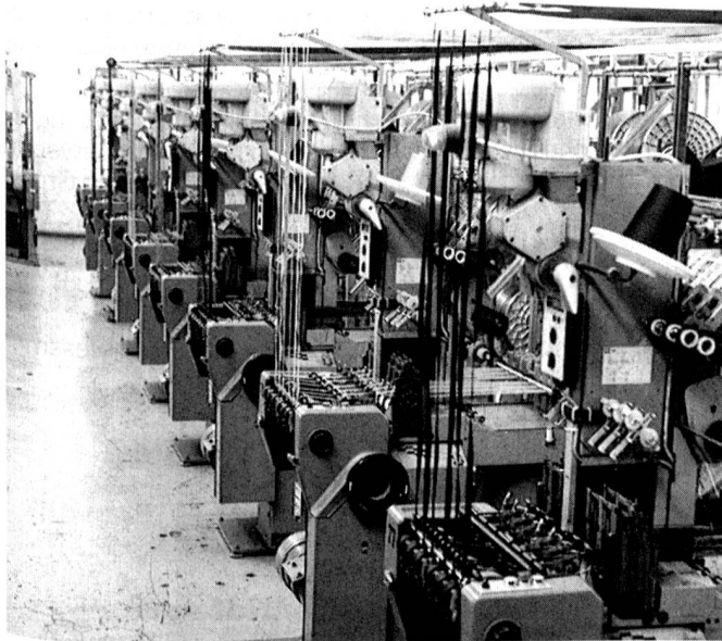
Modernste Technologie steigert Flexibilität, Qualität und Produktivität. Superschnelle Webautomaten (bis zu 3000 Schusseintragungen/min) sind Voraussetzung für ein gutes Preis-/Leistungs-Verhältnis.
