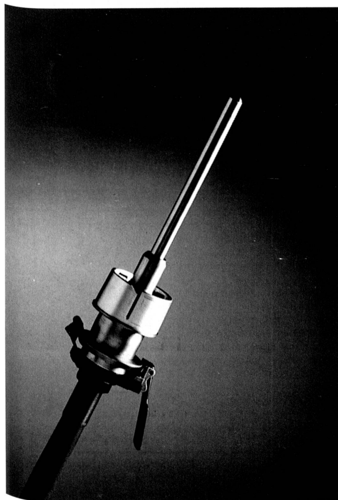
Ein Produkt von SMM Uster, wie es weltweit millionenfach eingesetzt wird: Die VERTI-FLEX Schindel für breite Einsatzbereiche in Spinnereien und Zwirnereien.
