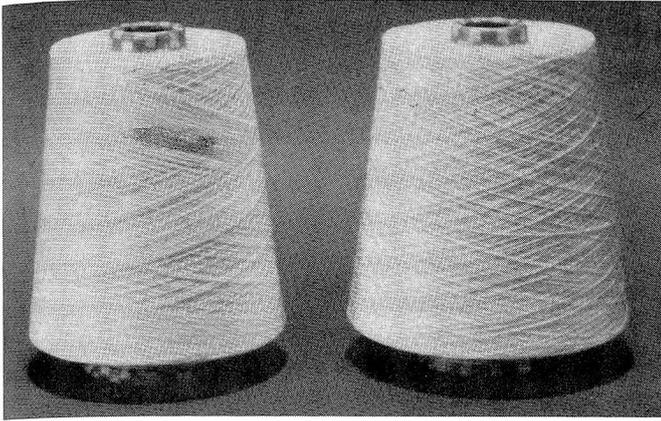
Bild 8 Spulen mit Wilder Wicklung mit Bild-(Spiegel-)zonen
