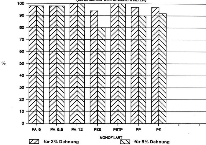
– Elastizitätsgrad (Je nach Rohstoff stellt sich nach einer Zugbeanspruchung das Material mehr oder weniger stark zurück. Das Diagramm zeigt das Rückstellverhalten bei einer vorangegangenen Dehnung von 2 und 5%. Bemerkenswert ist das sehr gute elastische Verhalten der Polyamide.)
