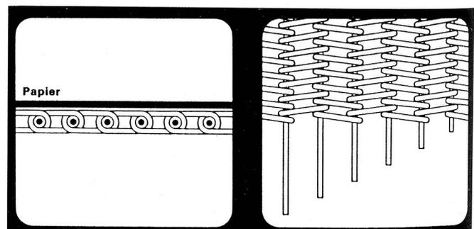
Beeindruckend ist auch die breite Palette von Monofilgeweben, die bei Monofildurchmessern von einigen tausendstel mm und Schusszahlen von über 400 Schüssen pro cm beginnt und bei Geweben mit Maschenweiten von ca. 1 cm und Drahtdicken von 1 mm aufhört.
