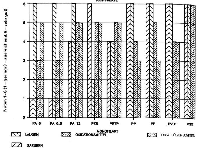
– Chemische Beständigkeit (Dieses Balkendiagramm dient als Richtwertangabe. Die genauen Beständigkeiten sind von Fall zu Fall abzuklären und eventuell durch Tests zu überprüfen. Für solche Abklärungen sind folgende Angaben unerlässlich: Chemikalie – Konzentration – Einwirkungszeit – Temperatur)
