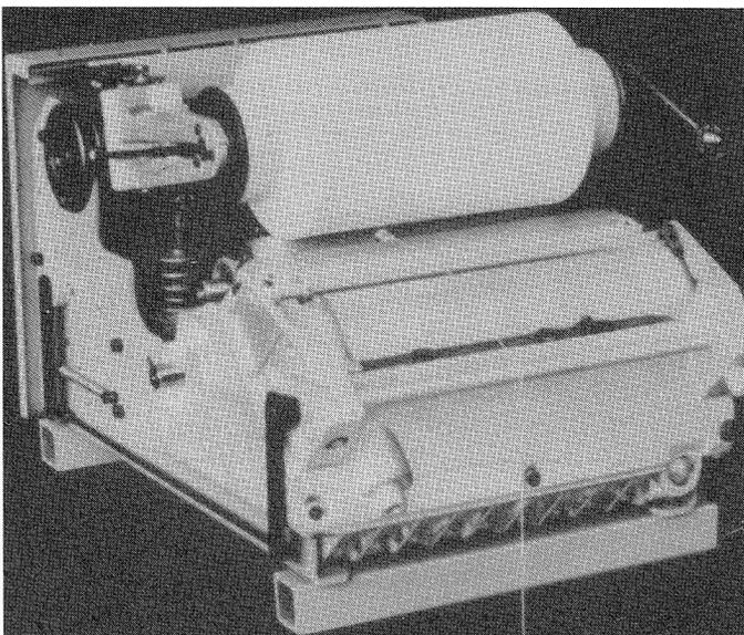
Bild 17 DIGICONE®-Spulaggregat
