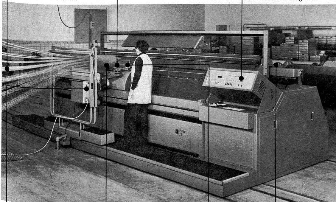
Druckknopf-Bedienung Schärseite für automatische Folgesteuerung bei Bandwechsel:
