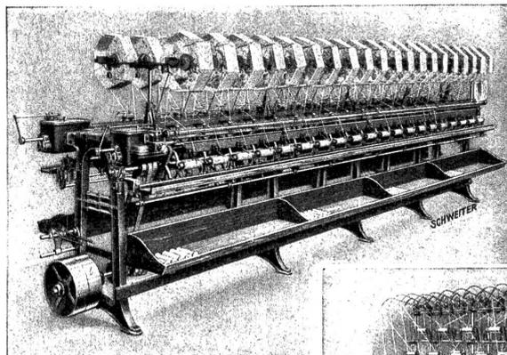
Pat. Spindellose Windmaschine
