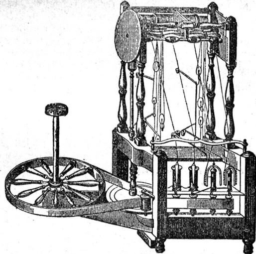
Abb. 2. Arkwrights Spinnmaschine.
