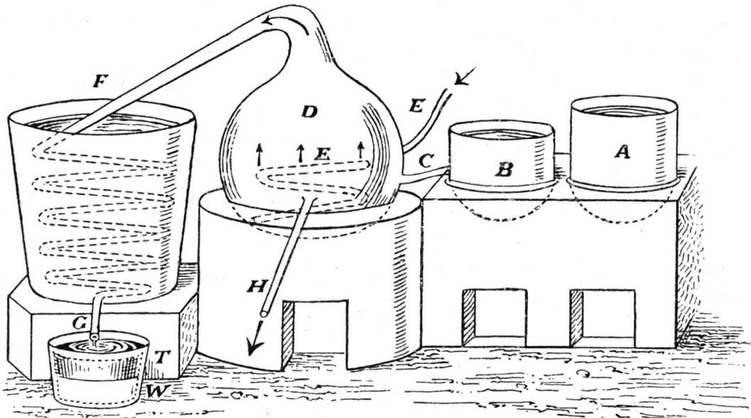
Fig. 4. Fabrication de la térébenthine par distillation.
