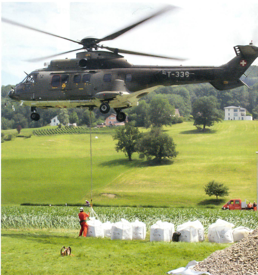
Der Cougar T-338 nimmt Sandsäcke von je 1,5 Tonnen auf und fliegt sie zum Damm.
