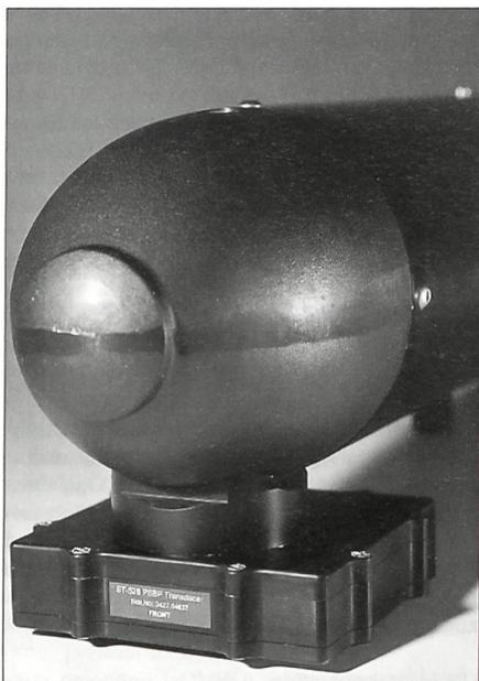
drohne macht daraus ein System, das diese Minen aufspüren und vernichten kann. Ein wichtiges Element dieser Funktionskette ist der auf dem Unterwasserfahrzeug angebrachte Sensor zur Relokalisierung der Mine. Der Funktionsnachweis für diesen Sensor ist jetzt gelungen.
