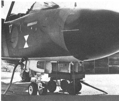
Der auf unserer Foto in einer meißelförmigen Verkleidung am vorderen Unterrumpf eines Tornados integrierte Laserkopf des LRMTS ist im Bereiche von  $\pm 90^\circ$  rollstabilisiert und hat einen Höhenrichtbereich von  $+3$  bis  $-20^\circ$  sowie einen Seitenrichtbereich von  $\pm 12^\circ$ . Für die Verwendung mit den Flugzeugtypen Jaguar, Harrier und Tornado baute Ferranti Ltd bis heute weit über 500 LRMTS-Anlagen. ka
