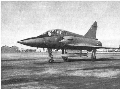
erreicht je nach geflogenen Einsatzprofil Eindringtie- fen zwischen 50 und 100 km. Neben dem Mirage 2000N (1988) sollen in einer ersten Phase auch 18 Mirage IV (1987/88) und später 50 Super Etendard (1988) mit der ASMP bestückt werden. Die auf unserem Foto an der zentralen Rumpfstation eines Mirage-2000N-Prototyps hängende ASMP misst 5,38 m in der Länge und verfügt über eine Spannweite von maximal 0,956 m. ka
