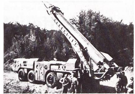
DDR-Volksarmisten bedienen eine Boden-Boden-Rakete vom Typ SCUD-B/MAZ-543 irgendwo in der DDR. Dieses Waffensystem ist eine einstufige Artillerie-Lenkrakete auf Selbstfahrlafette montiert.
