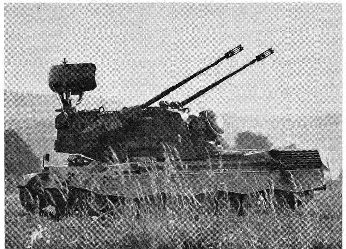
Auf grosses Interesse stiess der Oerlikon-Contraves-Flabpanzer (Typ B) für die Bundesrepublik. Im Turm des auf einem Leopard-Fahrgestell rollenden Flabpanzers befindet sich die von Contraves entwickelte Elektronik (Radar, Freund-Feind-Erkennungsanlage, Contraves-Rechner). Ausserhalb des Turmes befinden sich die beiden 35-mm-Oerlikon-Hochleistungskanonen mit einer Schusskadenz von 550 Schuss pro Minute. Die Besatzung dieses Fliegerabwehrsystems setzt sich lediglich aus drei Mann zusammen.
