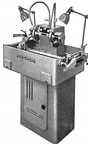
**Präzisions-Schleif- und Lappmaschinen für Hartmetall-Werkzeuge**
