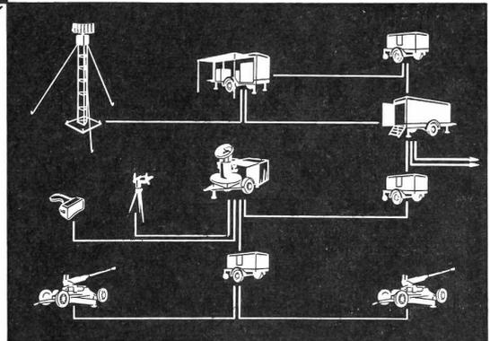
für mittlere und schwere Fliegerabwehr mit automatischer Zieleinweisung, Richtgeräten mit Feuerleit-Radar, elektronischen Rechengeräten und Geschütz-Fernsteuerungen.
