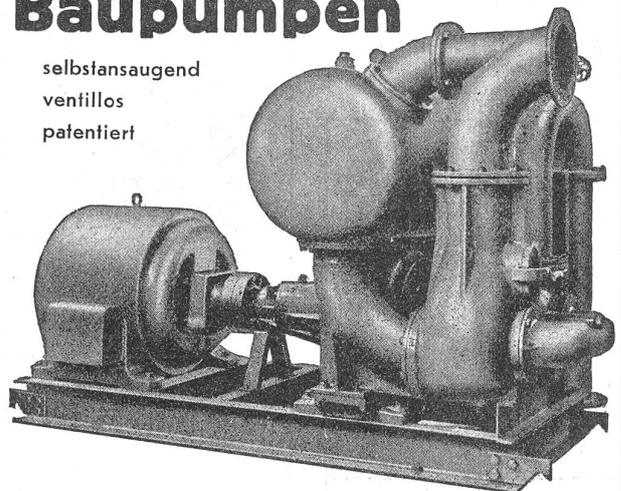
Saughöhen bis 9 m, Leistungen 1 bis 500 Liter/Sek. Kein Bodenventil - Keine Klappe im Saugstutzen - Keine Hilfs-Vakuum-Pumpe - Jederzeitiges autom. Ansaugen auch nach Lufteintritt im Saugrohr. Keine reibenden, sich abnützenden Flächen, daher unempfindlich gegen Sand, Schlamm und Kies.
