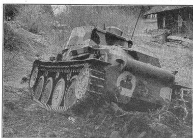
Die Ueberschreitfähigkeit von Gräben ist abhängig von der Länge des Fahrzeuges; sie schwankt zwischen  $\frac{1}{2}$  und  $\frac{3}{4}$  der Gesamtlänge. (VIB 1360.)
