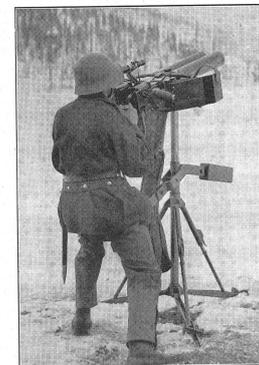
Links: Zwillingen-Fliegerabwehr-Maschinengewehr mit Zielfernrohr zur Abwehr von Tiefangriffen. (VIB 1175.)
