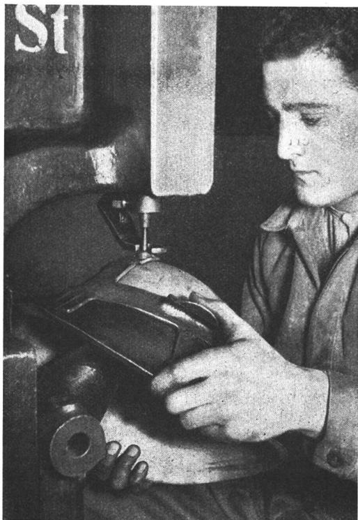
Nach vollendetem Ziehen der Helme werden in erster Linie die Ventilationslöcher eingebohr, wobei eine spezielle Schablone über den Helm gestülpt wird.
