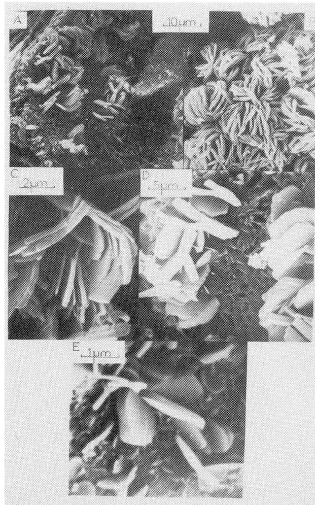
Fig. 10 Concrétions de plaquettes de lithiophorite au MEB.
