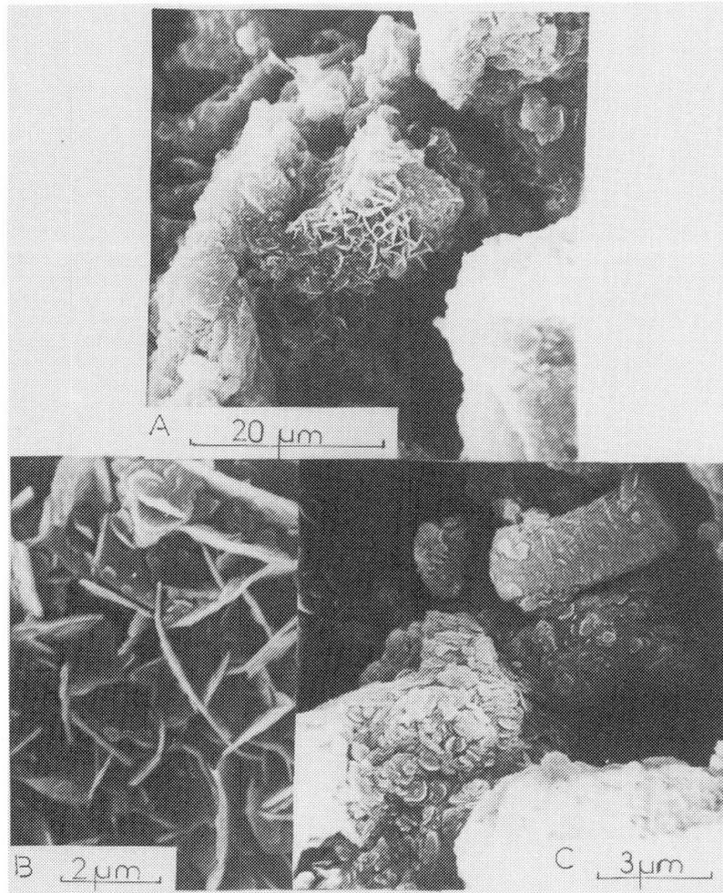
Fig. 11 Formation de la lithiophorite sur la trame des grenats (gisement de Tambao - Haute Volta) MEB.
