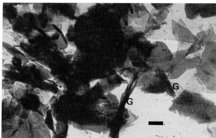
Fig. 14 Association intime des plaquettes de lithiophorite avec la goethite - G - ( $\alpha$ -FeOOH) dans les latérites de la Nouvelle Calédonie (Microscope électronique à transmission, le tiret = 1  $\mu$ ).
