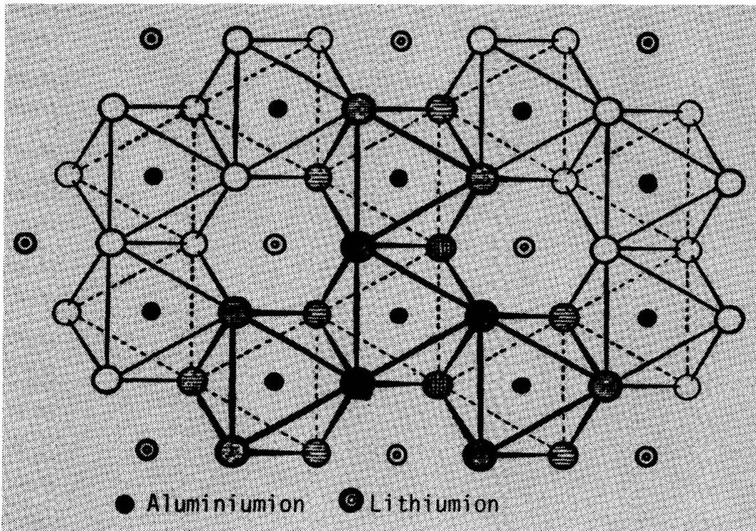
Fig. 2 Schéma d'une couche d'octaèdres  $[Al, Li(OH)_6]$  condensés. Les positions des ions  $Al^{3+}$  et  $Li^+$  sont ordonnées. Les octaèdres  $[Li(OH)_6]$  peuvent être vides. La couche entière remonte à la composition idéale  $[Al_2Li(OH)_6]^{+2}$ .
