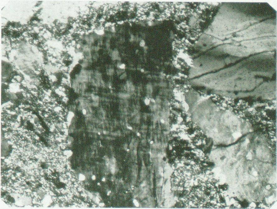
Photo n° 16. Gros fragment de feldspath potassique finement treillissé (macles de l'albite et de la péricline). Echantillon Roffna n° 11.
