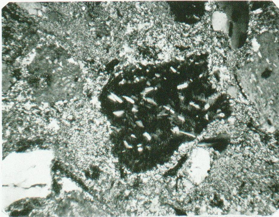
Photo n° 4. Pâte quartzo-feldspathique séricitique cimentant des fragments de quartz et de feldspath potassique à inclusions microlitiques d'albite. Echantillon Roffna n° 2.
