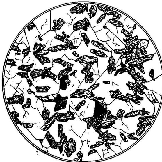
Abb. 14. Chloritoidführender erzarmer Smirgel. Korund weiss mit Rissen und Korngrenzen, Chloritoid starkgestrichelt, Høgbomit kariert, Magnetit schwarz, Goethit (an Magnetit) punktiert, Diaspor schwachgestrichelt.
