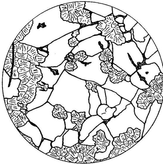
Abb. 15. Chloritoid-Smirgel (Akçakavaklar). Korund weiss, Chloritoid radialgestrichelt, Diaspor enggestrichelt. Vergr.: 55  $\times$ .
