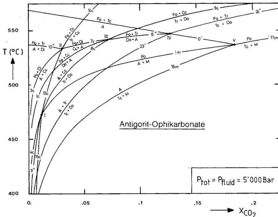
Fig. 11 Antigorit-Ophikarbonate. Die den Reaktionskurven 13c, 16m und 23\* entsprechenden Paragenesen treten innerhalb weniger cm im Untersuchungsgebiet auf. Sie dokumentieren eine bis in den Zentimeter-Bereich wirksame interne Pufferung der fluiden Phase.
