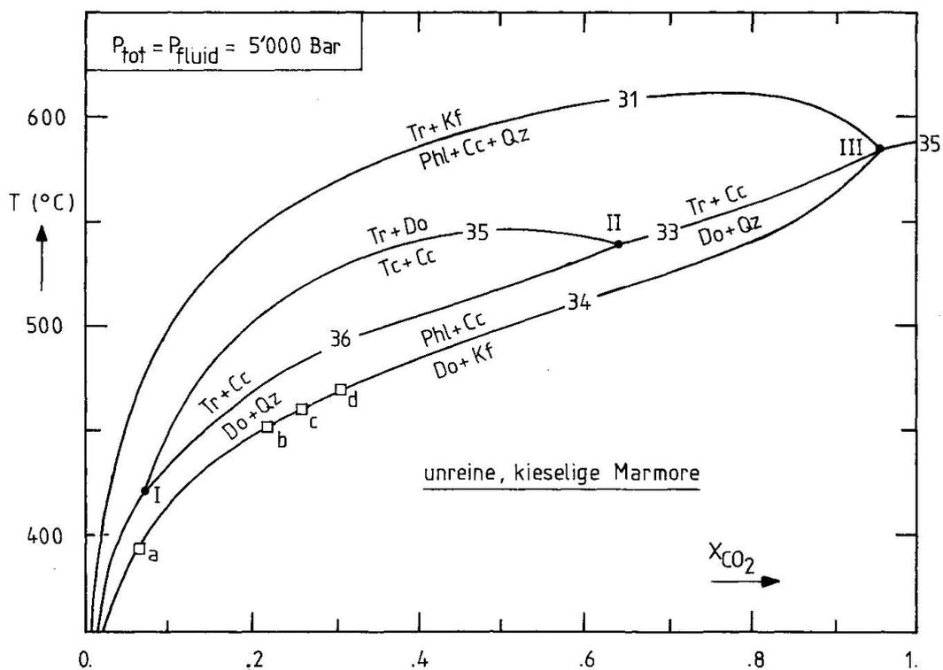
Fig. 13 Unreine, kieselige Marmore. Die Vierecke a, b, c, d markieren diejenigen Temperatur- und X<sub>CO<sub>2</sub></sub>-Werte, bei welchen vier verschiedene, heute dolomitfreie Kalzitmarmore die Reaktionskurve nach Aufbrauchen des Dolomites verliessen. (Topologie nach RICE, 1977.)
