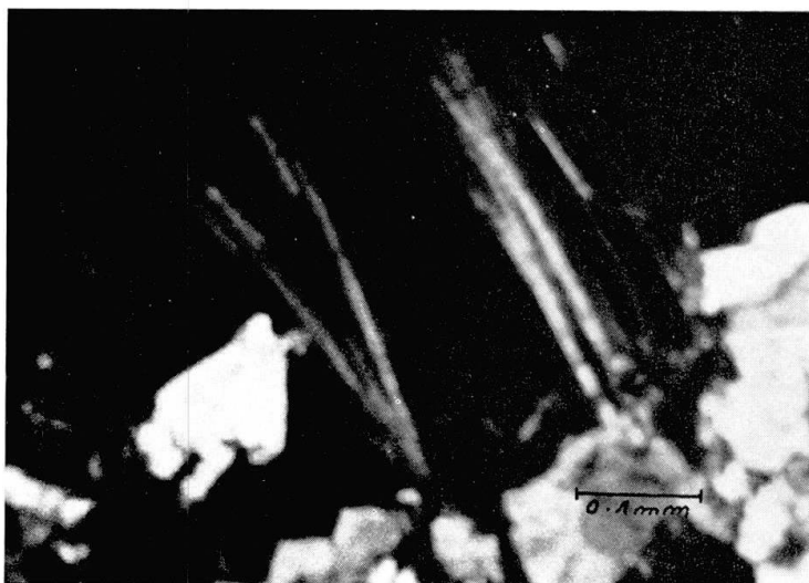
Fig. 10. Dünnschliffaufnahme Milarit Val Strem, mit einwachsenden Amianthnadeln, Aufnahme mit gekreuzten Nicols.
