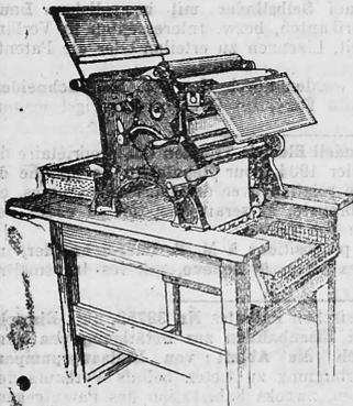
Legt die Schriftstücke selbsttätig ein. Locht und schneidet die Kopien selbsttätig. Ist eingerichtet für Gas- und elektrische Trocknung, sowie für Hand- u. elektrischen Betrieb.
