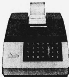
**Diehl Decima** Addieren, subtrahieren, saldieren, vollautomatisch multiplizieren und dividieren. 1 echter Speicher, Rückübertragung, Kommaautomatik bis 4 Stellen. Kapazität 12/13stellig. Fr. 2900.–
