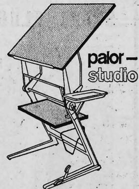
Das Zeichnungs Brett des palor-Studio kann mühelos in jede gewünschte Lage gebracht werden. Es lässt sich durch eine Klemmvorrichtung in verschiedener Höhe horizontal und in jeder Schräglage fixieren. Schwere Zeichnungsblätter bleiben durch die Wirkung von Federkraft auch bei gelöster Klemmvorrichtung im Gleichgewicht. Prospekt durch
