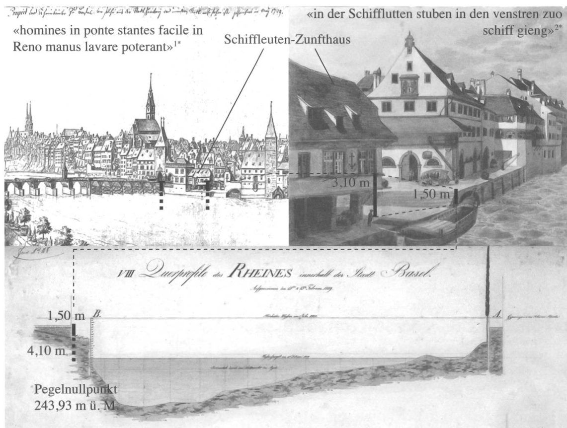
Abb.4: Rekonstruktion der Höhe der alten Rheinbrücke: Fensterhöhe (3,10 Meter) + Schifflande über Pegelnullpunkt (4,10 Meter) = Höhe der Brücke (7,20 Meter). Links oben: Blick auf das linke Rheinufer, 1759, Zeichnung von Emanuel Büchel, StABS, Collection Weber-Oeri, Topo 2. Rechts oben: Blick von der Rheinbrücke auf das Schiffluten-Zunft- haus, vor 1839, Aquarell von einem unbekanntem Künstler, StABS, I 537. Unten: VIII Quer- profile des Rheines innerhalb der Stadt Basel. Aufgenommen den 12. & 13. Februar 1819, StABS, Planarchiv A 6, 8. Zitat 1*: «Die Aufzeichnungen des Kaplans Hieronymus Brillinger. 1447–1525», in: Basler Chroniken , Bd.7, Leipzig 1915. Zitat 2*: «Anonyme Zusätze und Fortsetzungen zu Königshofen, nach der Abschrift Erhards von Appenwiler 1120–1454», in: Basler Chroniken , Bd.4, Leipzig 1890.
