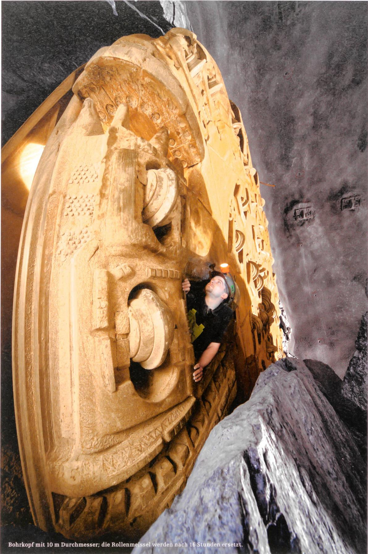
Bohrkopf mit 10 m Durchmesser; die Rollenmeissel werden nach 16 Stunden ersetzt.
